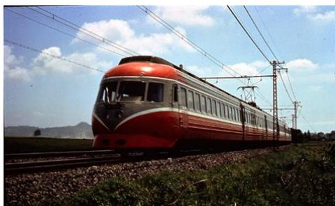
1957年就役。軽量化、低重心化に加え、空気抵抗を抑える超流線形の車両は、高速試験で当時の狭軌鉄道の世界最高速度（時速145km）を樹立しました。また、パーミリアンオレンジをベースにシルバーグレーと白線をあしらった斬新なカラーリングも話題を独占。1958年に第1回ブルーリボン賞を受賞、1992年に引退。
